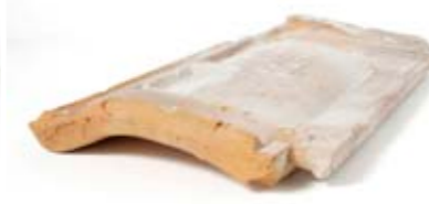
Formpressat tegel med falsar för att det ska ligga jämnare och tätare.
