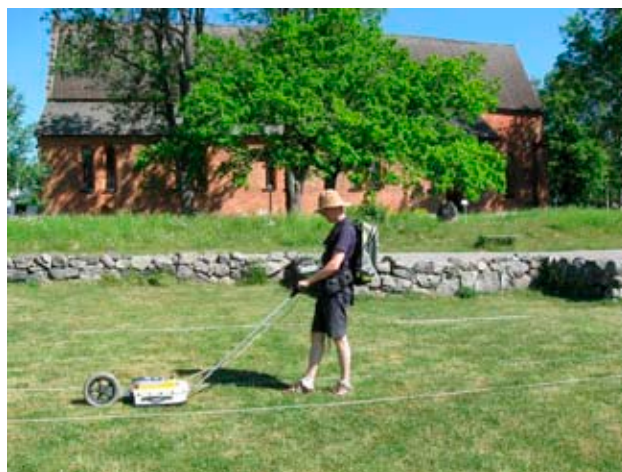
Figur 3. Georadarsystem från Malå Geoscience. Foto Joakim Schultzén
