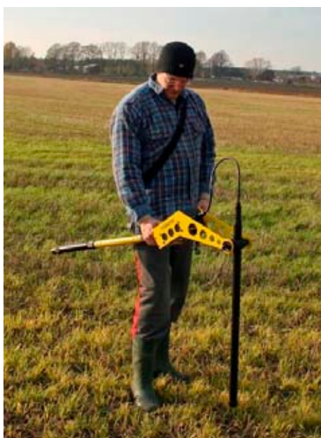
Figur 4. Gradiometer från företaget Foerster (Ferex DLG 4.032.) Foto: Ny Björn Gustafsson.
