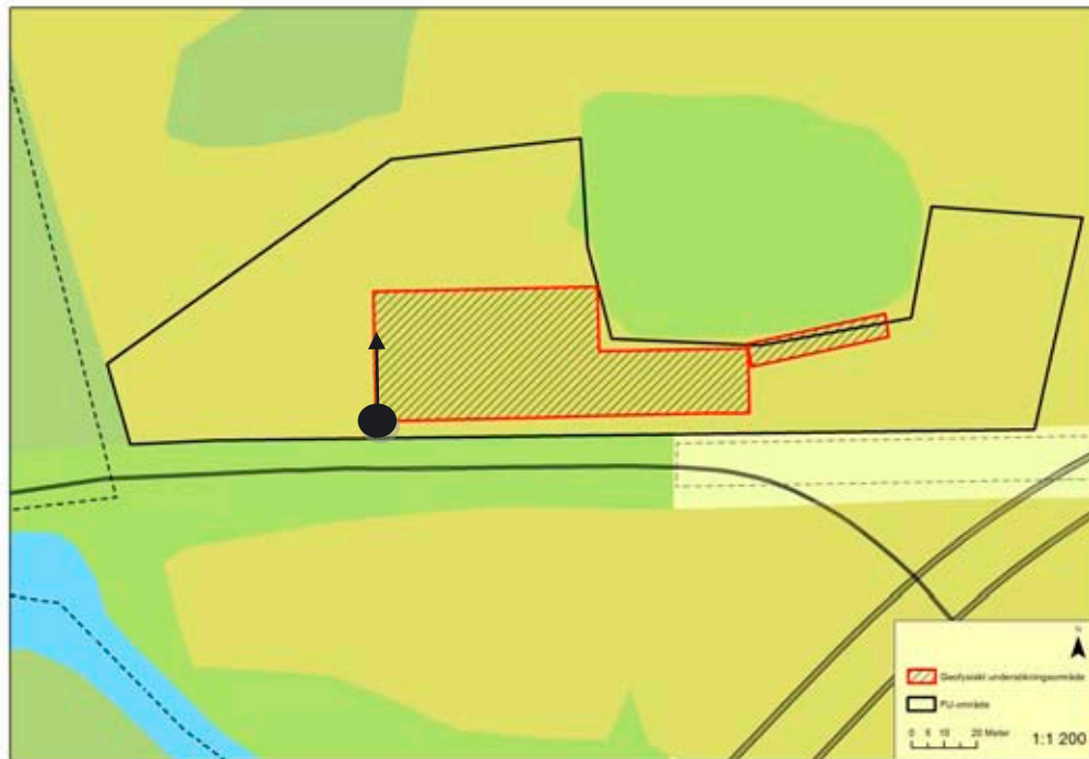
Figur 2. Översiktskarta som visar förundersökningsområdets avgränsningar (svart linje) samt det geofysiska undersökningsområdet (Röd ram, svart skaffring) i närheten av Hossmo kyrka söder om Rinkabyholm. Svart prick i figuren visar var mätningarna påbörjats i området och pilen anger riktning på första radarprofil och första magnetometerfil. Karta: Nicolas Nilsson (KLM) med tillägg av Andreas Viberg.
