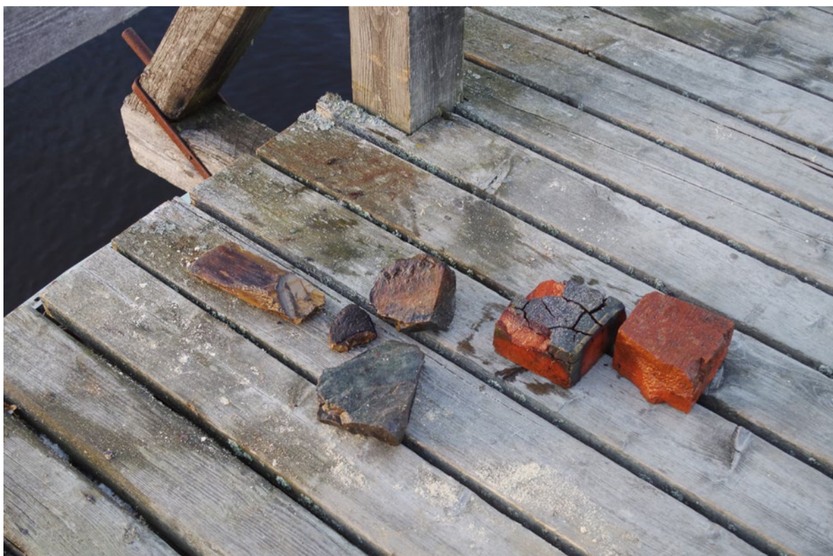
Figur 27. De fynd som påträffades vid dykningarna utgjordes av tegel och sten som använts som utfyllnadsmaterial under den äldsta bron samt huggspån.
