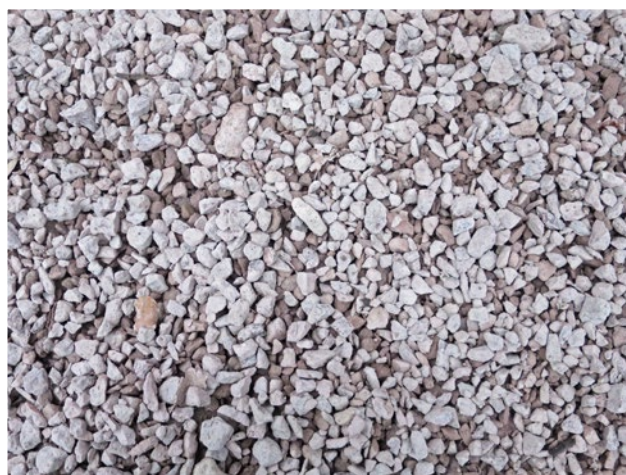
Den nygrävda dräneringen längs norra fasaden samt en detaljbild på makadamen som använts som dränerande skikt.
