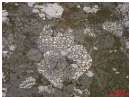
Ho105:5:4 02 Ett kraftigt oxiderat pyritkorn (gulvit) som ses finkornigt omvandlat till bl.a. ljusgrå Fe-hydroxid (rost).
