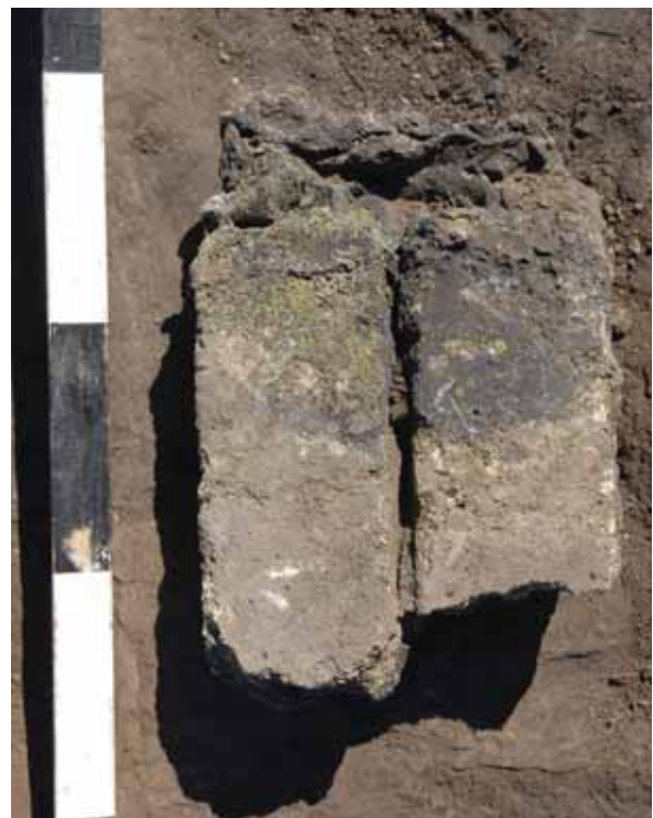
Fig 198. Del av ugnsvägg med eldfast tegel påträffade i smältverket Ho29:2 . Foto: F Sandberg, DM.
