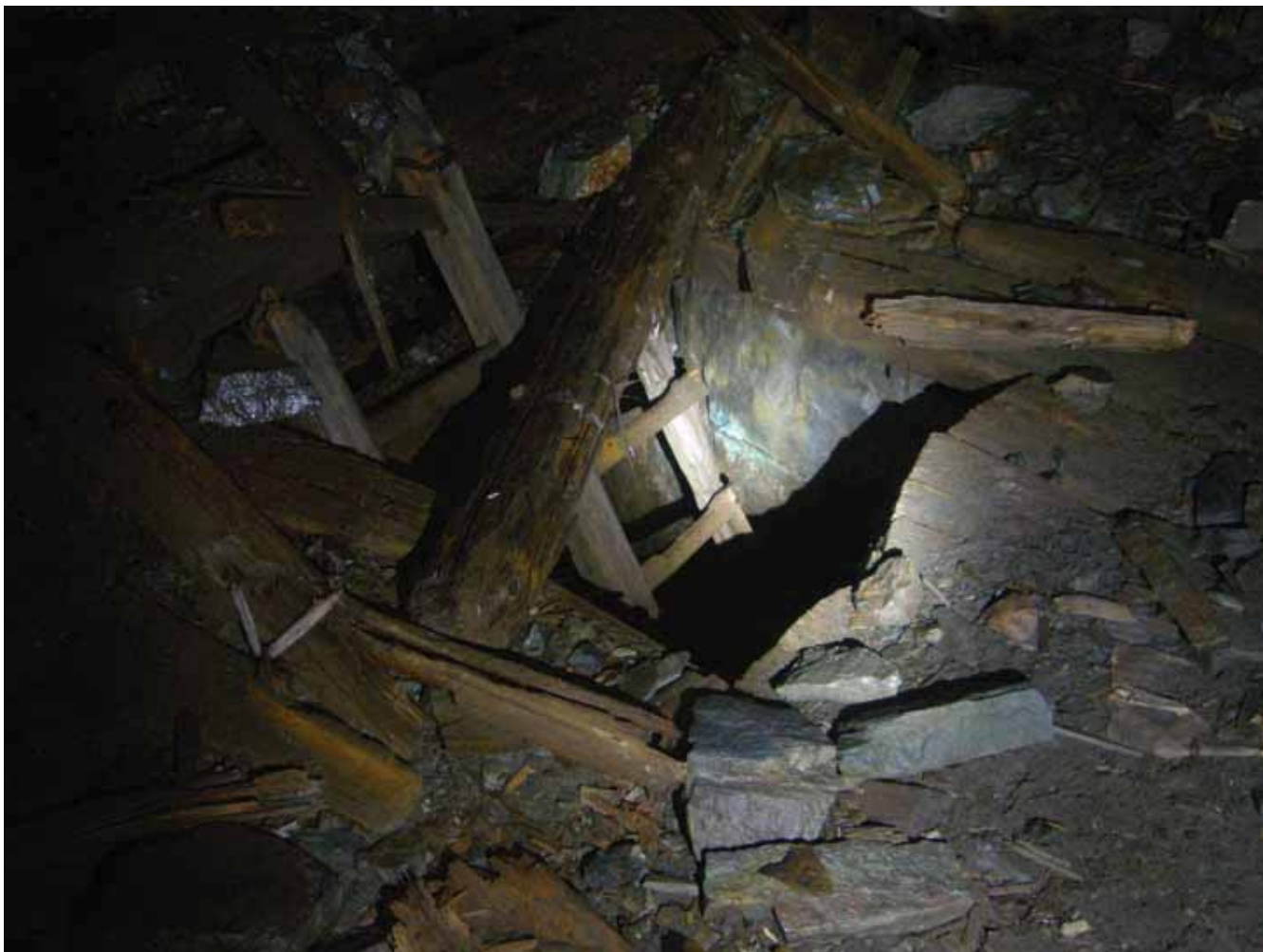
Fig 161. Stegen genom timmerbotten på 32 m nivån i Knuts schakt. Foto: B & S Gunnvall, 2009.
