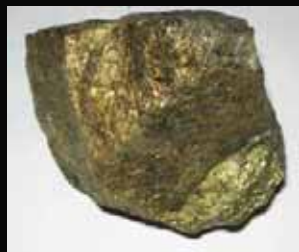
Fig 8. En stuf av kopparkis. Foto: Å Johansson, NRM.
