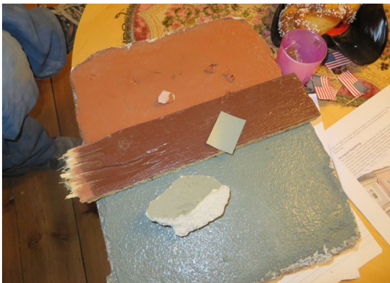
Kulörprover framtagna utifrån färgskikt på nedtagen puts.
