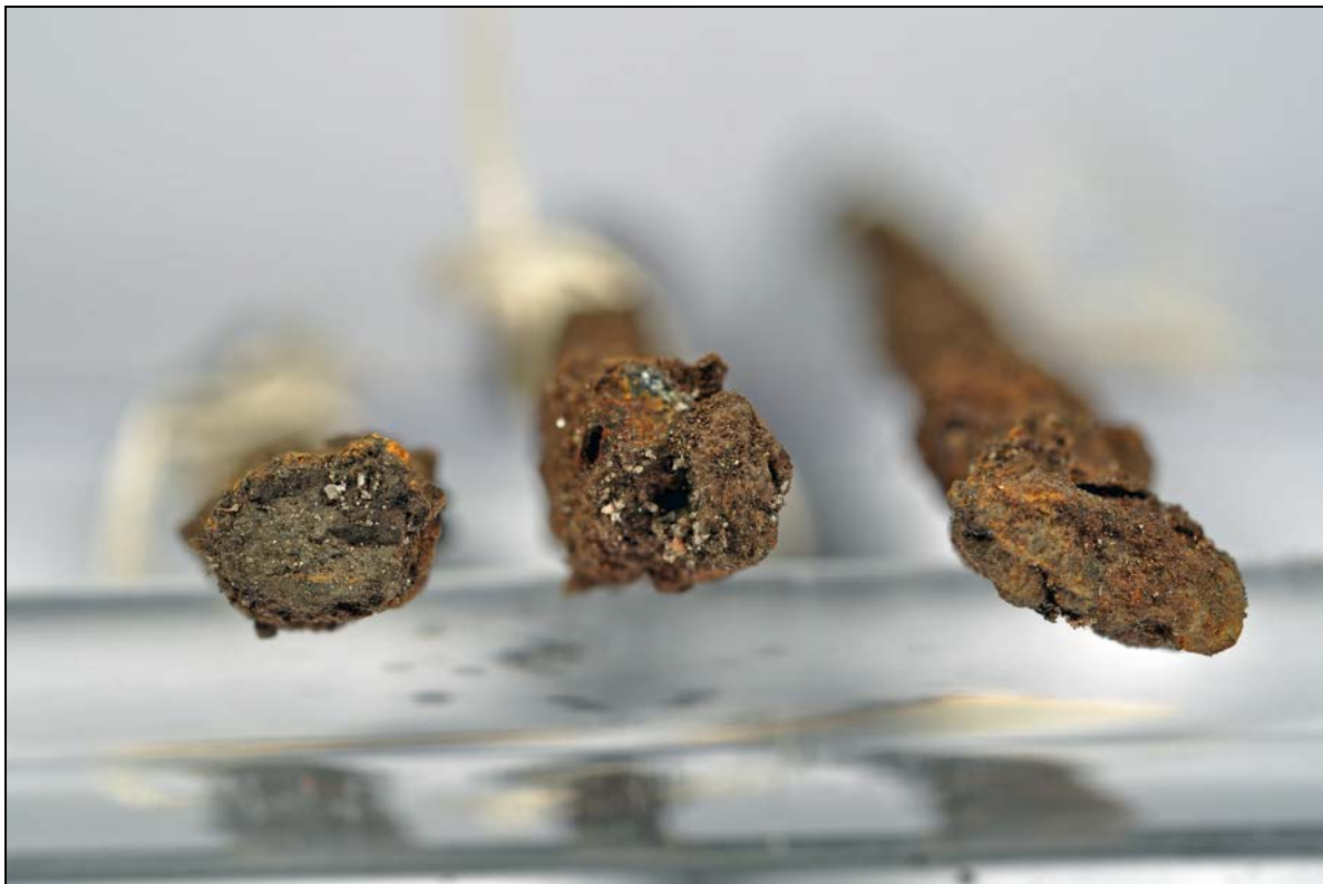
Olika typer av brottypor på stängerna, från vänster i bild 46, 30, 32:1.
