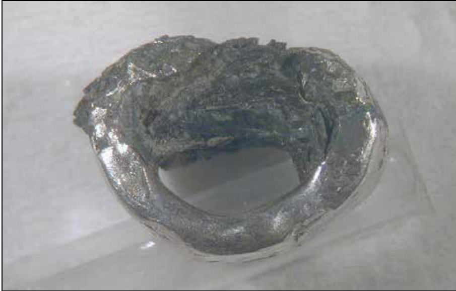
Öglans profil med en övergång från ett rektangulärt tvärsnitt till ett avrundat.
