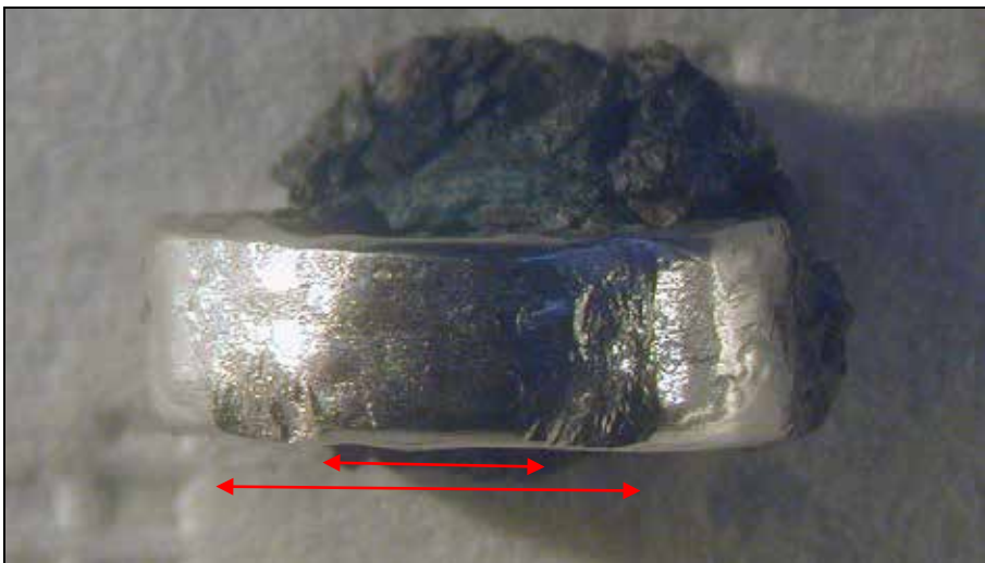
Spår efter nötning. Pilarna i bild har avståndet 3 mm respektive 6 mm.
