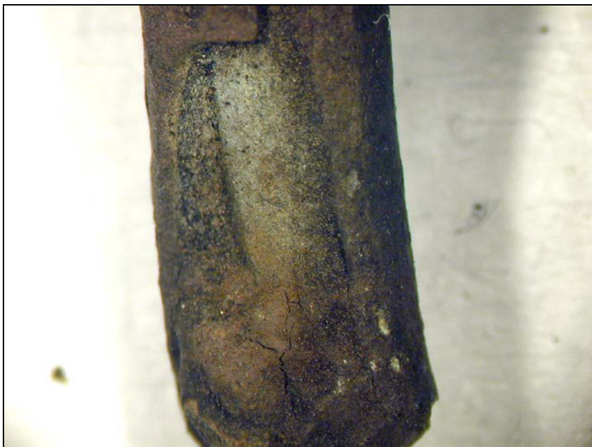
Skadan på det cylindriska blecket är av äldre datum och exponerar en hårt vittrad stång.
