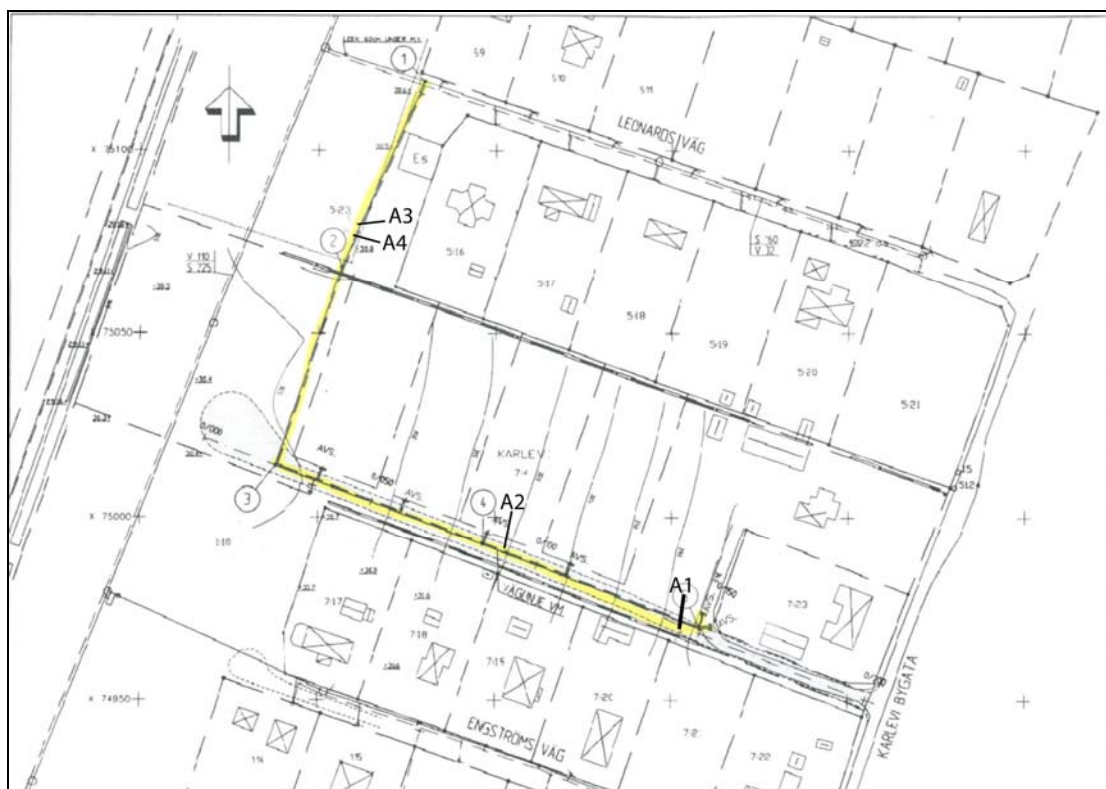
Figur 1. Ledningssträckan, (gul), med de påträffade anläggningarnas placeringar.
