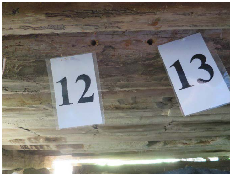
Prov 12 och 13 togs ur samma golvbalk. Prov 12 misslyckades delvis och kompletteras därför av prov 13.
