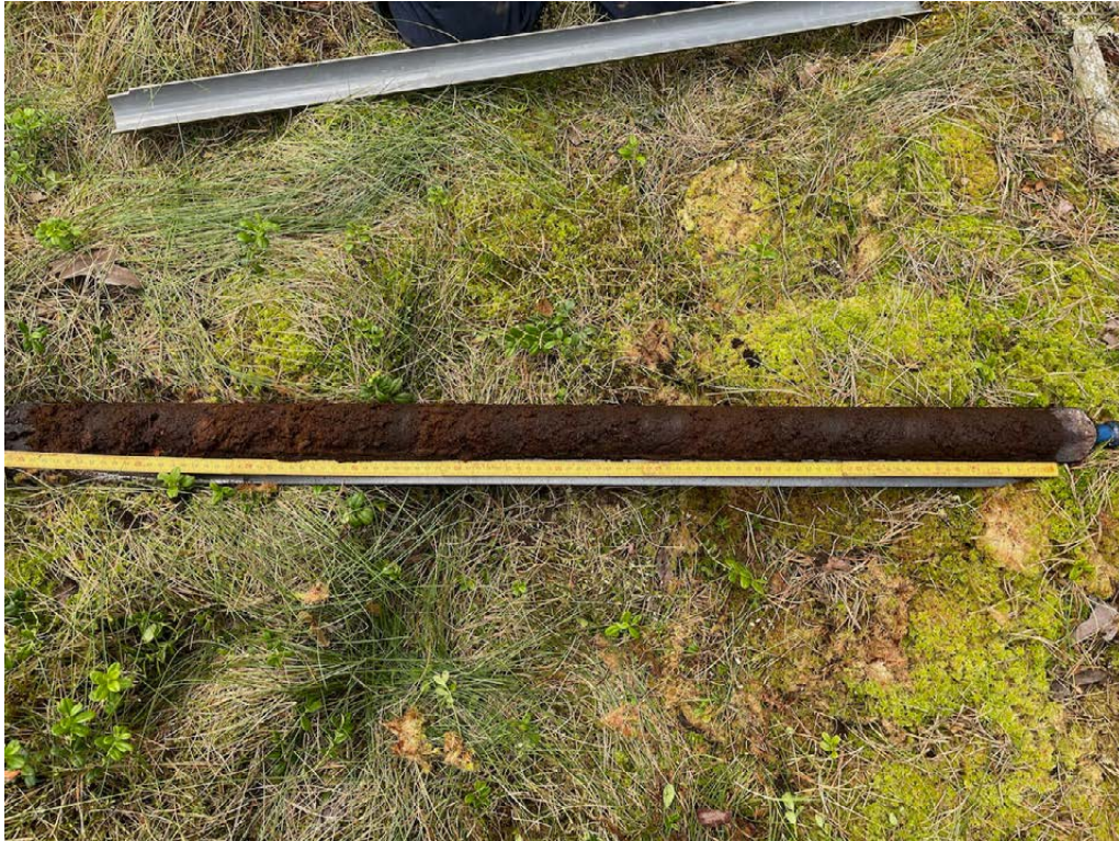
Figur 5. Mellan nivåerna 100–200 cm består lagerföljden också av vitmosstorv, som i detta avsnitt växlar mellan låg-, medel- och höghumifierad typ (se tabell 1). Uppåt är till höger i bilden. Foto: Leif Björkman, 2021-07-05.
