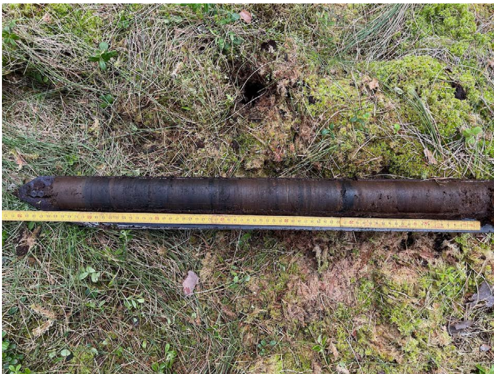
Figur 8. På bilden syns den allra nedersta delen av profilen mellan nivåerna 300–365 cm som till största delen utgörs av kärrtorv (tabell 1). I botten mellan 361–365 cm finns dock ett lager med grovdetritusgyttja. Uppåt är till höger i bilden. Foto: Leif Björkman, 2021-07-05.
