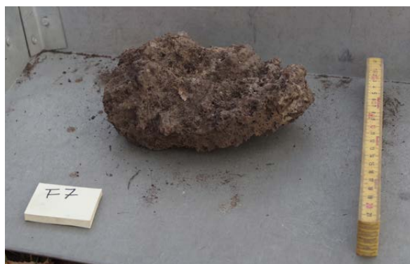
Figur 17. Foto av fynd från undersökningen. F2 slaggfragment, F4 fragment av kompakt lätttrunnen slagg, till vänster i bild, F5 fragment av kompakt lätttrunnen slagg, F7 oregelbundet ugnsväggsfragment av bränd lera och slagg.
