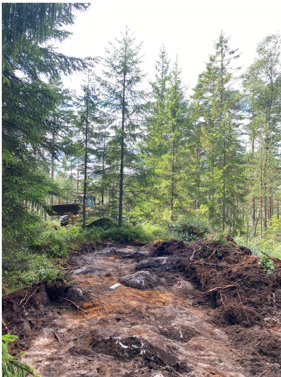
Figur 9. På kullarna som stack upp ur torvmossen utgjordes sedimenten av en grovblockig sandblandad morän.
