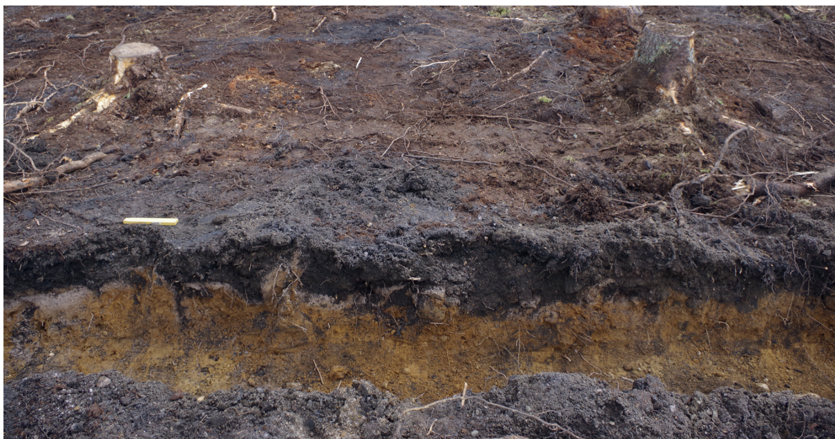
Figur 7. Det av kolbotten i profil efter profilschaktning. Under det täta kollagret fanns sand. Fotograferat från nordväst.
