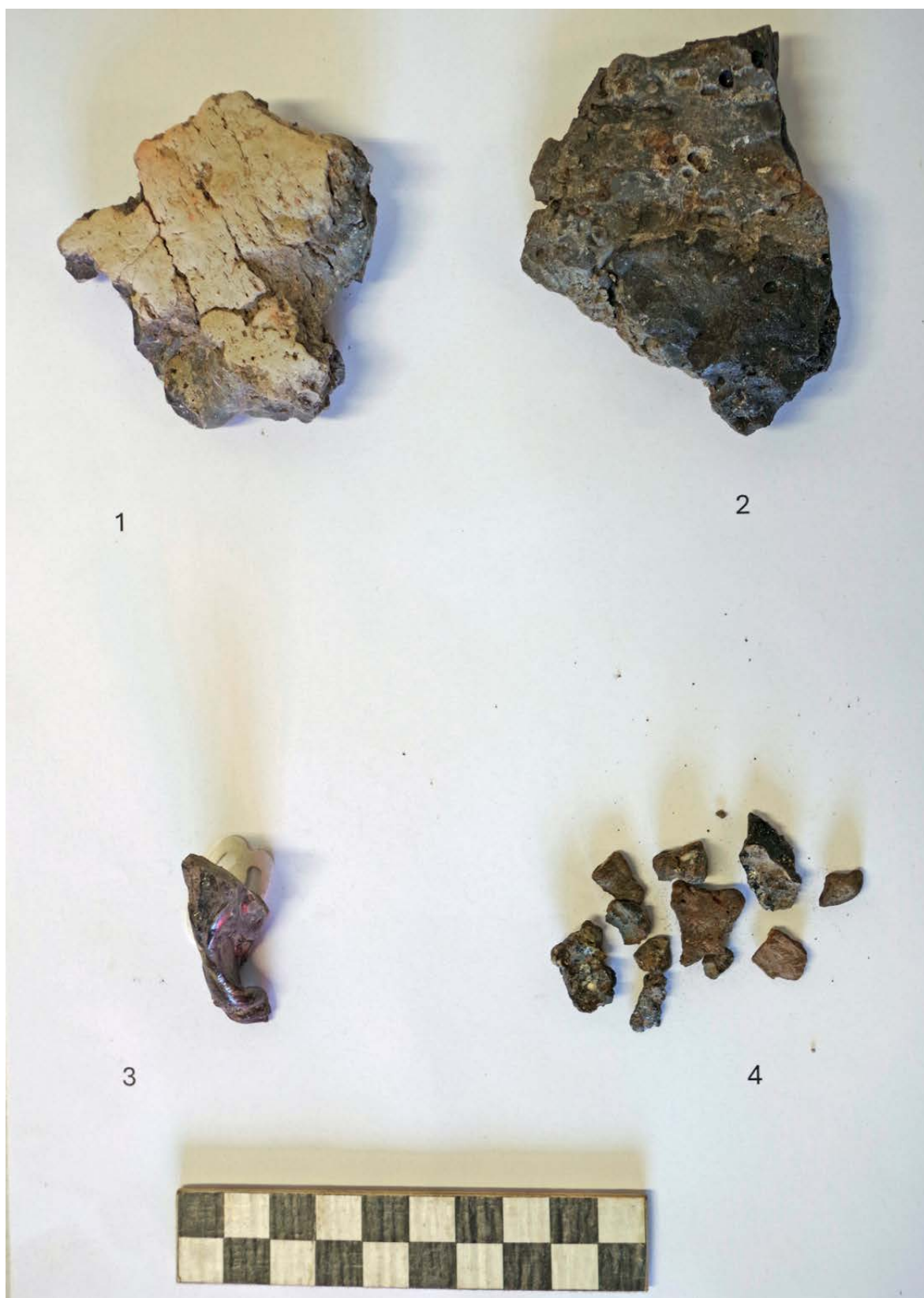
Figur 9. Några av fynden från blästplatsen. 1: ugnsväggsfragment av bränd lera, utsida (F6). 2: ugnsväggfragment i bränd lera, förslaggad insida (F1). 3: Slagg, sterarinrunnen form (F4). 4: Magnetiska slagger, fällslagg och avfall (F7).
