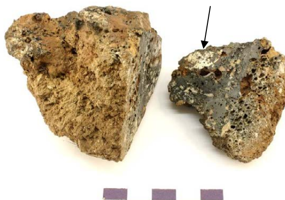
Figur 4. B Ugnsväggsfragmentet med lera och slagg. Tvärsnitt där också en koncentration av ljus metalliskt järn kan ses (vid pilen).
