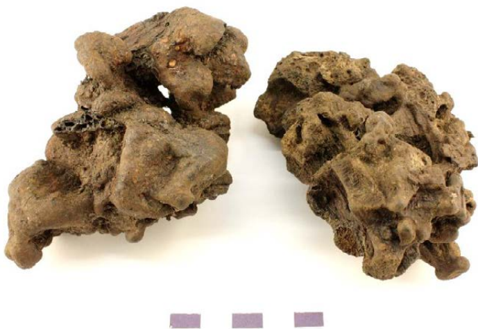
Figur 7. Slaggar som är uppbyggda av flera slagglöden.
